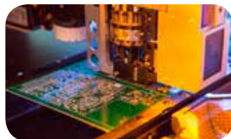
Montagem de placas
